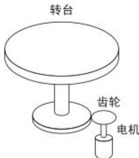
由于只能朝一个方向旋转，因此经过一定时间后，其旋转圈数总会超过绝对值编码器所能计数的上限值。
